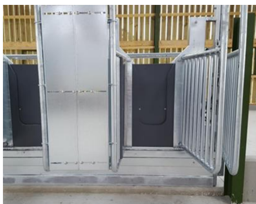
Figur 1. Om djuret har tillgång till foderträget öppnas den svarta luckan. Sidorna kan justeras för att anpassas efter djurets storlek. En antenn på den vänstra sidan registrerar djurets identitet (15).
