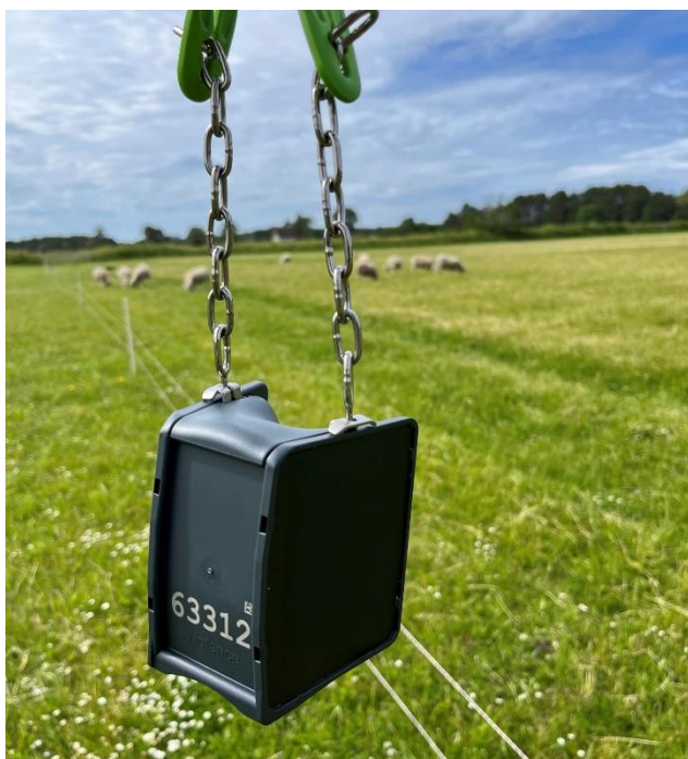
Figur 1. Halsband till får och getter från Nofence. Detta halsband användes i försöken beskrivna i denna rapport.
