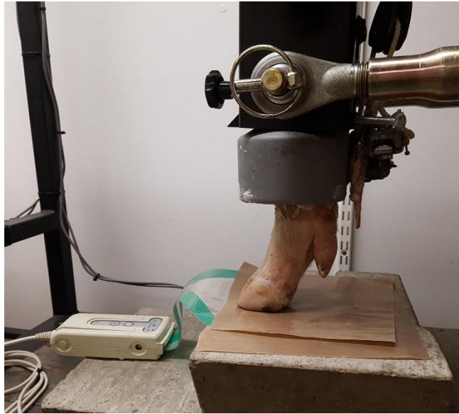
Figur 3. Test-rigg med saggens slaktben med trycksensor placerade under klöven.
